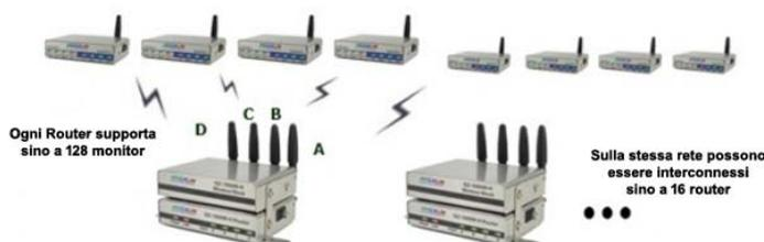
Ogni router wireless supporta sino a 128 monitor e sulla stessa rete possono essere interconnessi sino a 16 router. Significa poter monitorare in tempo reale oltre 4.000 postazioni di lavoro.
